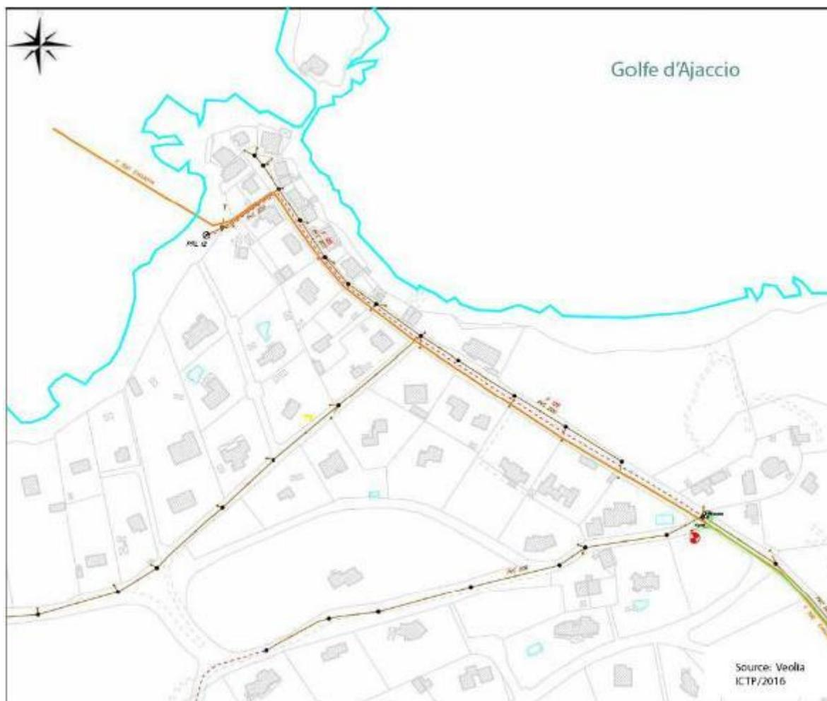
Figure 59 : Réseau d'assainissement et eau potable le long de la voie au-dessus de la plage d'Isolella nord (Veolia)
