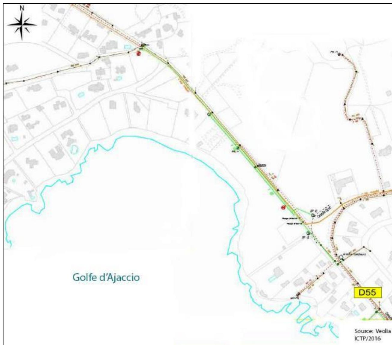
Figure 90 : Réseau d'assainissement et eau potable le long de la voie au-dessus de la plage d'Isolella sud (Veolia)
